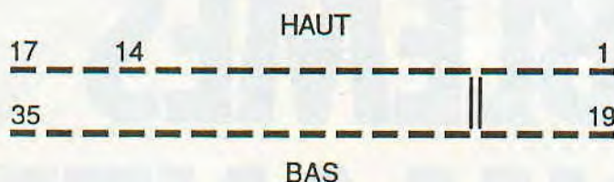
Sortie imprimante du CPC vue de l'extérieur. Les cosses 18 et 36 n'existent pas.
