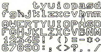
Figure 3 : Voici l'impression de la page "DEMONSTRATION3. On observe immédiatement les erreurs : Les caractères "w", "e" et "r" sont omis (lignes de DATA correspondantes non tapées). Les caractères "h" et "a" sont mal formés (une erreur s'est glissée dans la ligne de DATA correspondante).
